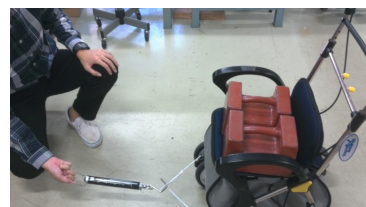
製品を設計するため歩行器の動き出す力を計測する大分大学の研究者
