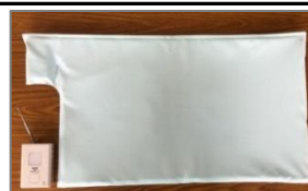
無線式圧力感知センサーマット
