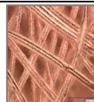
銅めっき不織布(拡大画像)めっき加工不織布の新たな医療・福祉関連機器への応用を考慮した各種試作品を展示します。
